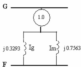
نبسط هذه الدائرة المكافئة وأولى خطوات التبسيط هو الاستعاضة عن جميع مصادر الجهد في الدائرة بمصدر وحيد كما هو موضح بالرسم المقابل، وكذلك نوجد المقاومة المكافئة لكل فرع من أفرع الدائرة، ونصل إلى معاوقتين على التوازي تكون المعاوقة المكافئة لها:
